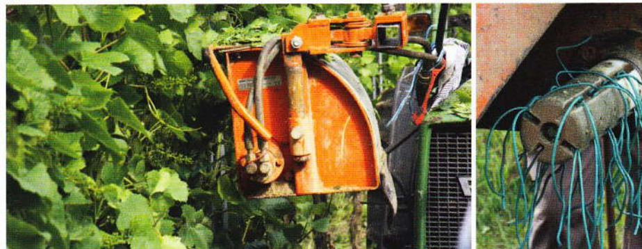
Zur Oppenheimer Traubenbürste wurde eine Braun-Stockbürste umgebaut. Als "Bürsten"-Material wurden bestimmte PVC-Bindeschläuche verwendet (Fotos: Prior)
